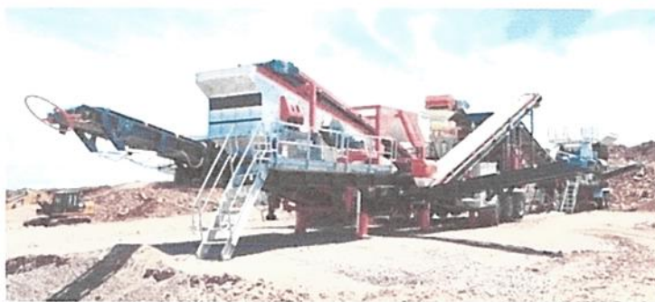
Ilustracija postrojenja za tretman neopasnog građevinskog otpada
